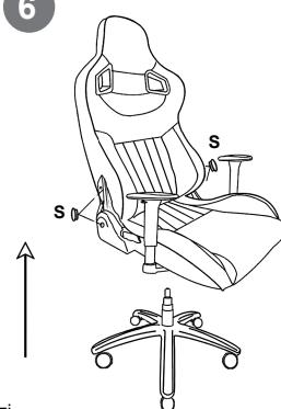
Aby se zabránilo možnému písčání, doporučujeme zajistit plastové O-kroužky mezi sedlem **B** a mechanismem **C** a zajistit je šrouby.
