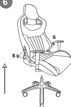
Для предотвращения возможного скрипа, мы рекомендуем Вам зафиксировать пластиковые кольца **O** между сидением **B** и механизмом **C**, закрепив болтами
