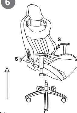
Pentru a preveni posibila scărțăire, vă recomandăm să fixați înesele din plastic **O** între scaunul **B** și mecanismul **C**, fixându-le cu șuruburi
